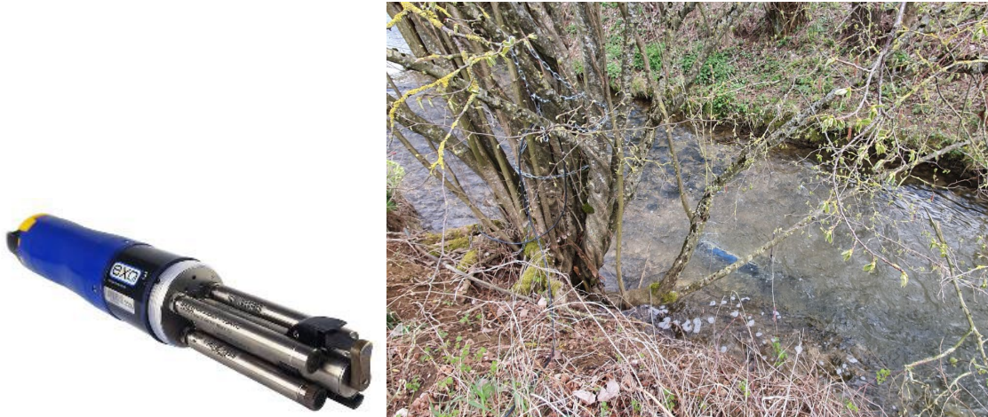
Figure 1: Sonde multiparamétrique installée dans l'Allaine. Photo F. Fernex, ENV
